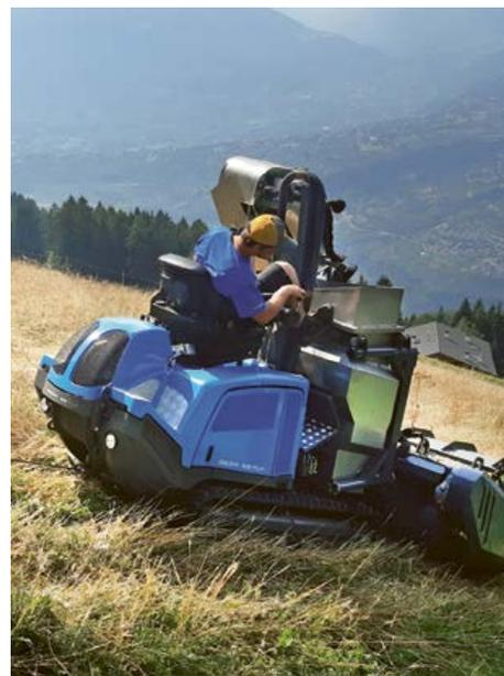
Know-how altoatesino: prototipo di una macchina da raccolta per terreni ripidi. Il veicolo cingolato è appeso a un argano.
